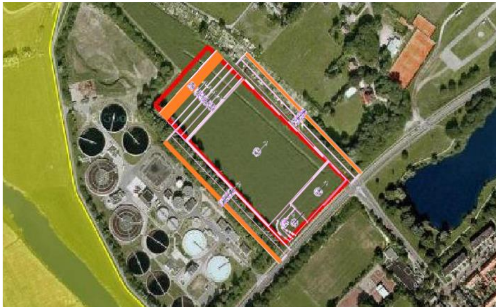
Modelberekening lichtintensiteit (waarden in Lux). De oranje vlakken zijn de delen met een grenswaarde van 0,25 lux. (Bron: Infralux, 2013)
