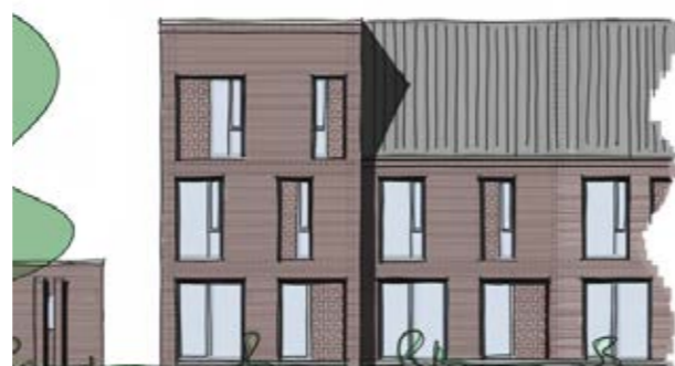
Eigentijdse topgevels plat afgedekt
