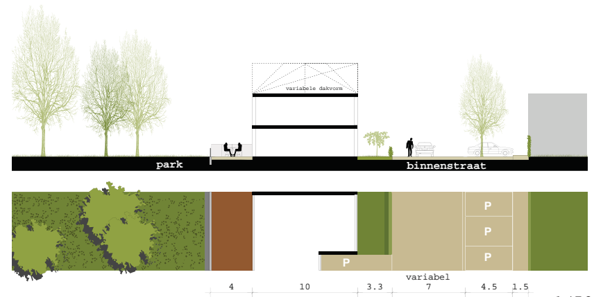
b-b' 3 bouwlagen aan parkzijde waaronder evt een dak
