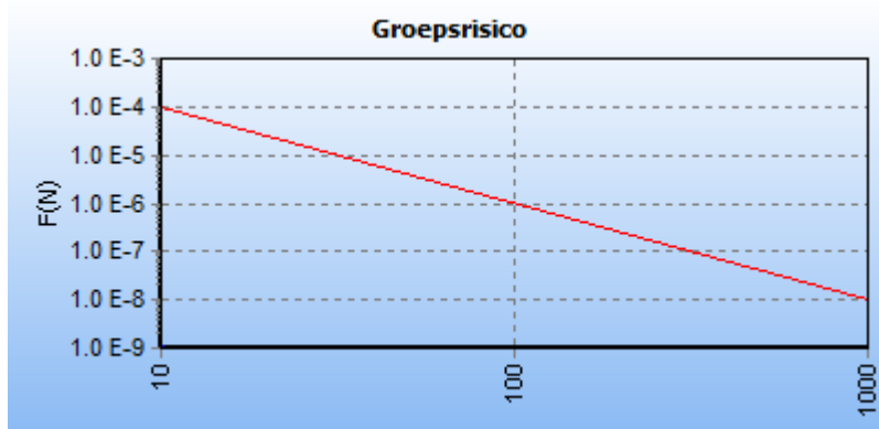
Figuur 2.10: fN-curve buisleiding N-557-36 vóór planrealisatie
