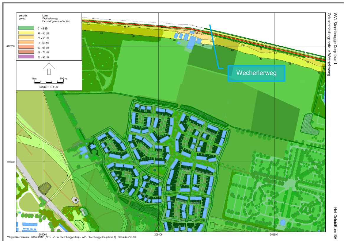
Figuur 3.3 Geluidbelastingcontouren Wechelerweg (beoordelingshoogte 4,5 meter)
