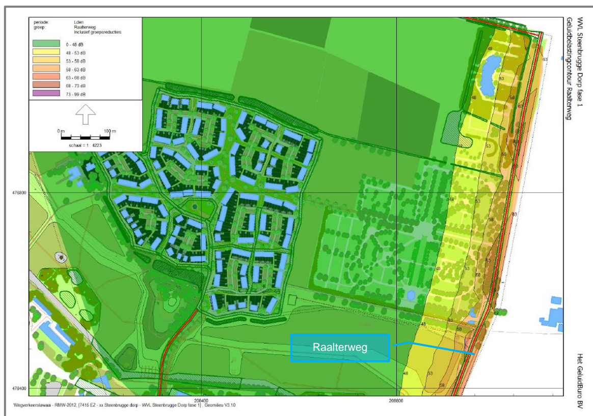
Figuur 3.2 Geluidbelastingcontouren Raalterweg (beoordelingshoogte 4,5 meter)
