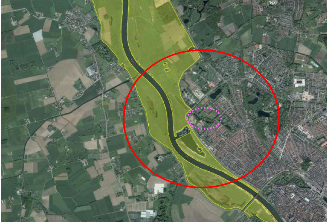
Figuur 6.1 Ligging maximale 47 dB(A)-contour (rood) tijdens aanlegwerkzaamheden
