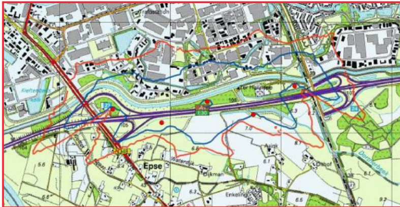
Figuur 20: Slagschaduwcontouren van 5:40 uur (rood) en 15 uur (blauw)
